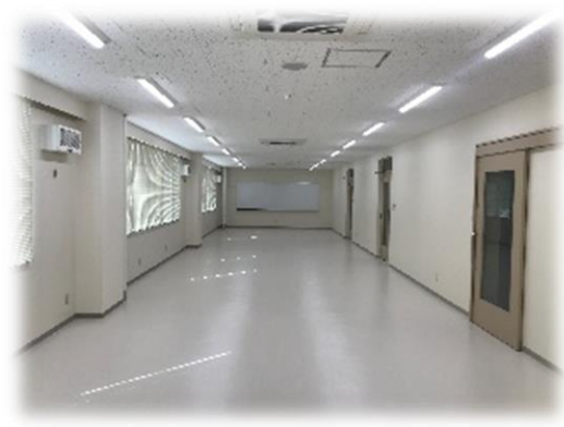
LED照明、高効率空調、複層ガラス
