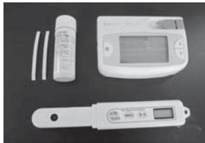
図2 尿糖検査用試験紙(上左), 酵素分析装置(上右), 及び糖分計(下)
