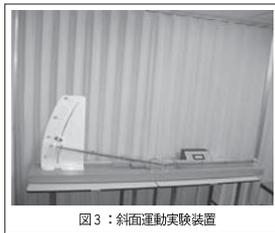
図3：斜面運動実験装置
